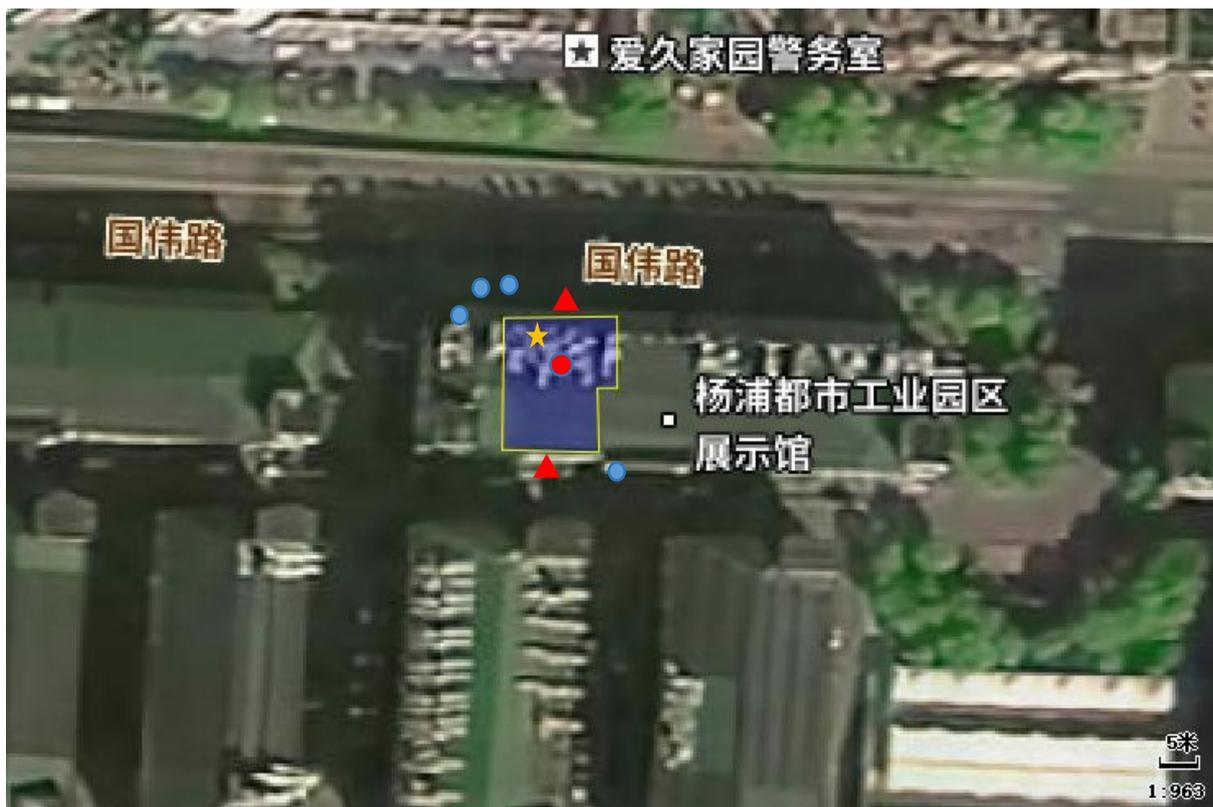
▲噪声监测点      ●有组织废气监测点      ★均质槽排口      ●无组织废气监测点      □项目边界
