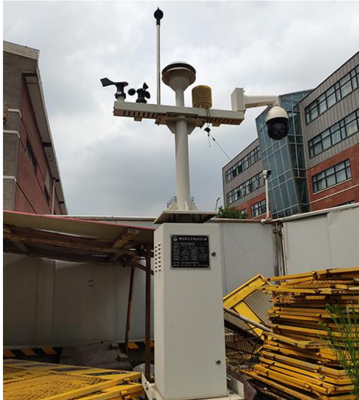
图 5.13-1 开发商施工现场噪声及扬尘监测仪器 运行期环境监测计划见表 5.13-1。
