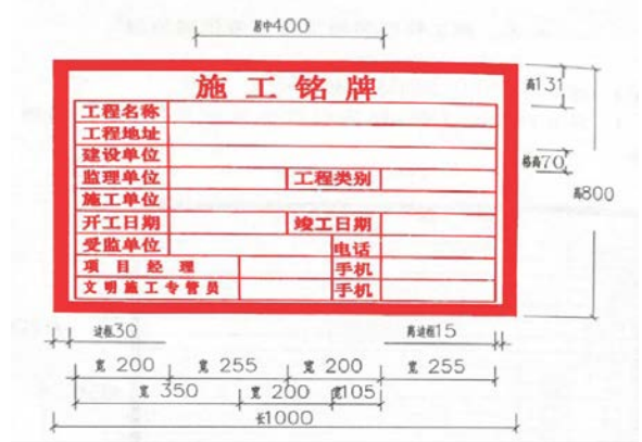
图 11 设置路栏的市政工 地施工铭牌
